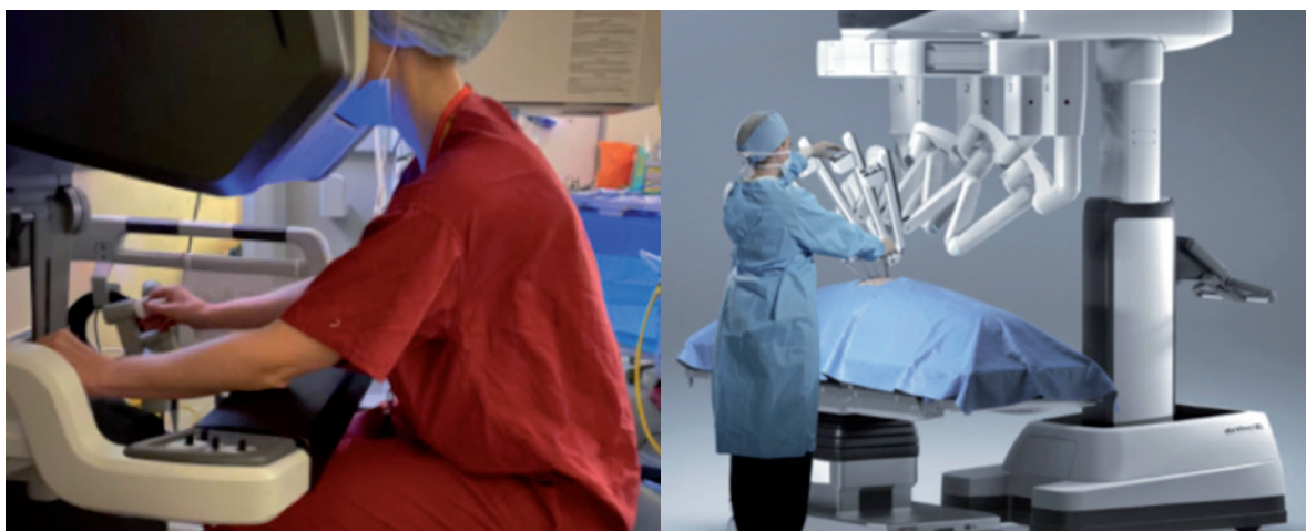
Figuur 3: Da Vinci Intuitive Surgical vierde generatie robotsysteem (rechts), die wordt bediend door de chirurg aan de console (links). (Bron: www.therobotreport.com/intuitive-surgical )
